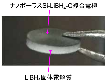
図 1. ナノポーラス Si 負極活物質、 \text{LiBH}_4 固体電解質を利用した全固体リチウムイオン二次電池（写真は折茂研究室・松尾講師からご提供いただいた）
