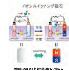
充放電でON-OFF制御可能な新しい電磁石 スピンイオンの性質を利用して、二次電池に新しい機能を付加するための研究に取り組みます。
