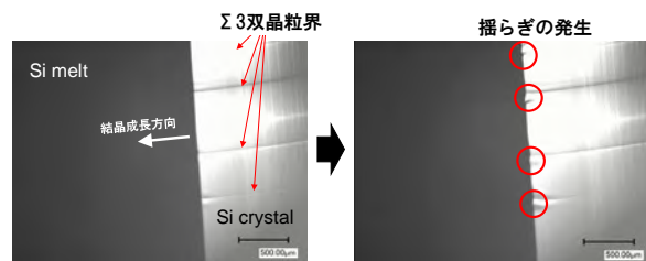
図1. 双晶粒界を含んだ Si の固液界面不安定化の様子。
