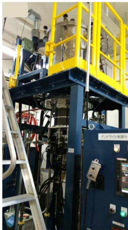
図2 太陽電池用Si多結晶インゴット成長装置
