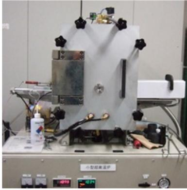
Figure 3-2. オープンセルポラス炭素の構造を制御するための超高温熱処理炉
