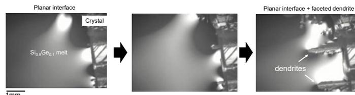
図1  $\text{Si}_{0.9}\text{Ge}_{0.1}$  融液からの一方方向凝固過程。
