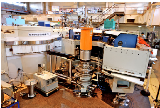
研究用原子炉 JRR-3 に金属材料研究所が設置している中性子回折装置（左）と中性子分光器（右）。原子とスピンの位置および運動に関する情報を得ることができます。
